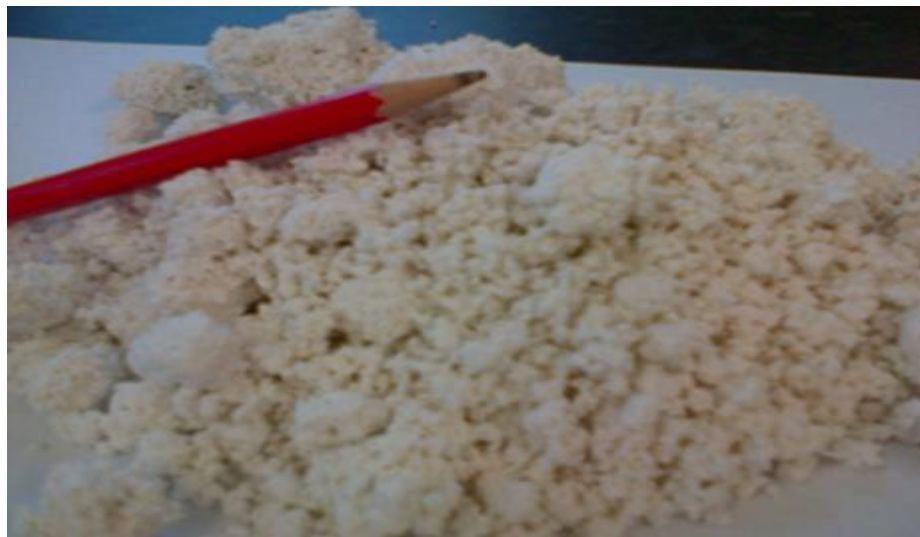
Forma del producto de torta de filtración FiberLean (30% sólidos, 50% MFC)
